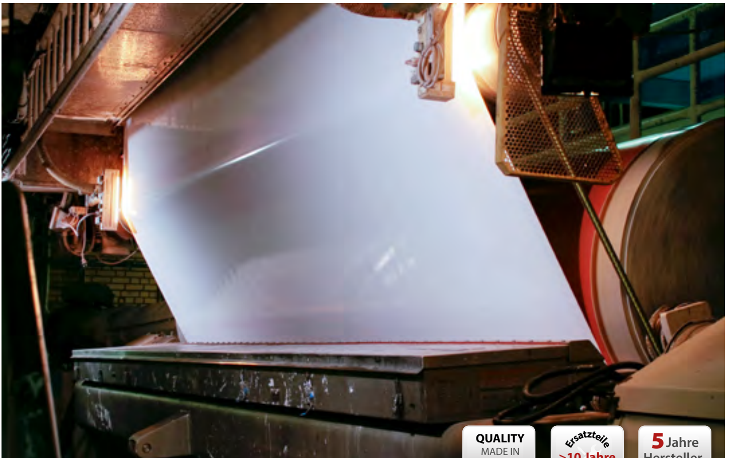
Hochtemperaturleuchten an der Papier-Trocknungsanlage
