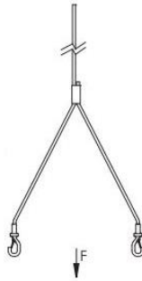
2 mm starkem Stahlseil, Y-Form mit 2 vormontierten Haken, 2 m (O1186) oder 7m (O1187) lang 2 mm thick steel cable, Y-shaped with 2 pre-assembled snap hooks, 2 m (O1186) or 7 m (O1187) long
